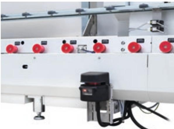
Зона загрузки и выгрузки с лазерным сканером.
