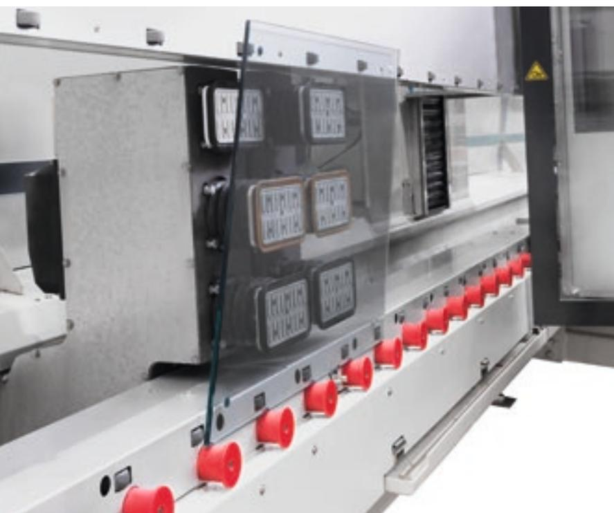
Моторизованная система роликов позволяет загружать стекло в любой момент, так что машина начинает работать полностью автоматически.
